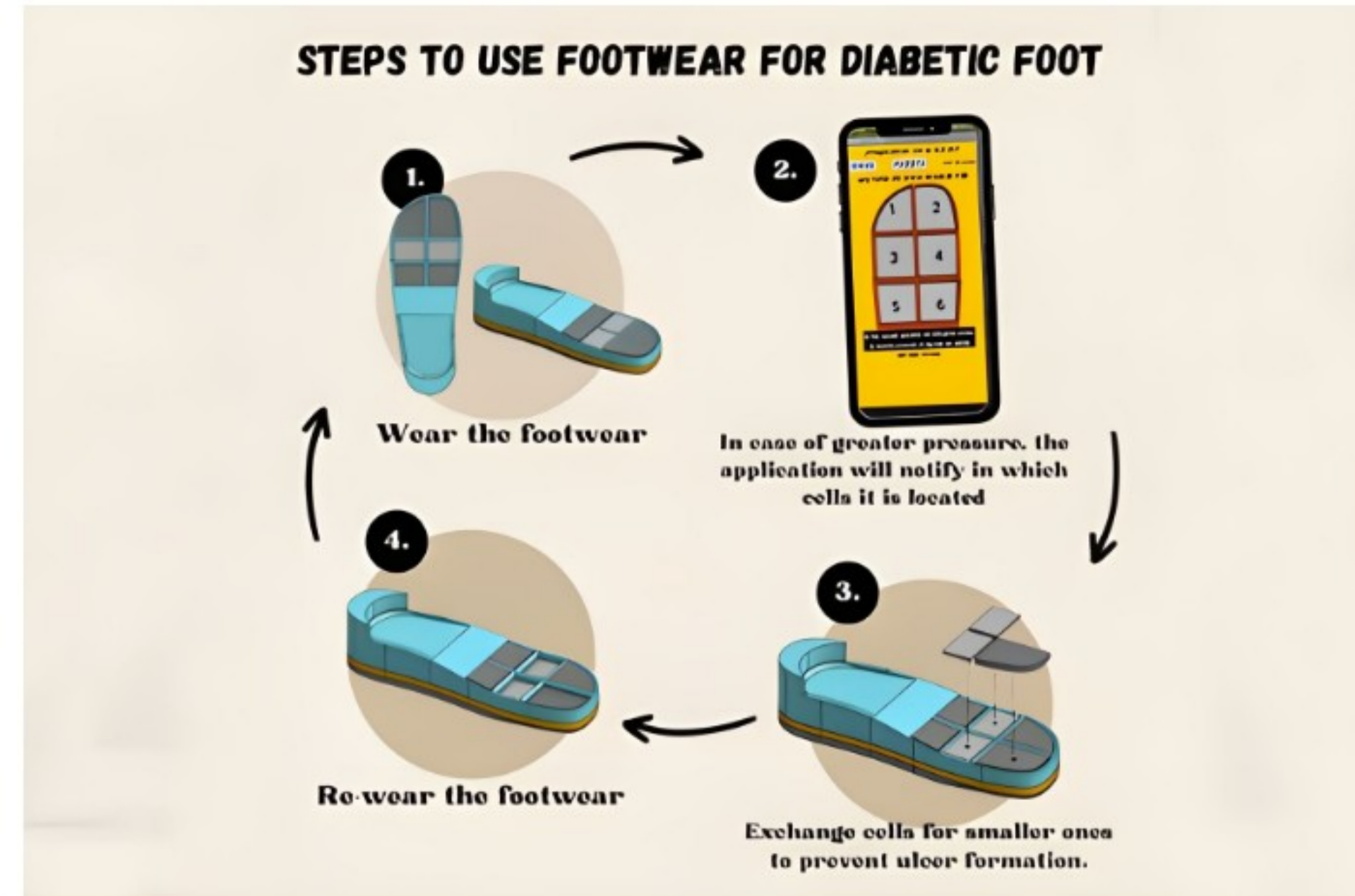
El calzado especial dispone de tres capas de células que se adaptan a la presión plantar del paciente diabético y ayudan a evitar las úlceras de pie. Foto: Cortesía.
